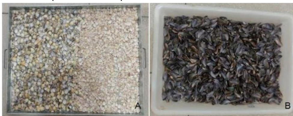
De acordo com a Figura 3(a), a maioria do material ficou retido nas peneiras com abertura de malha 6,3 mm e 4,75 mm, o que se aproxima dos percentuais da brita. A diferença entre o acumulado médio e o limite mínimo da peneira com abertura 6,3 mm foi superior a 5% do limite exigido pela NBR 7211 (2005). Em compensação, a peneira com abertura de 4,75 mm atendeu a esse limite e adotou-se como ótima toda a faixa granulométrica.
