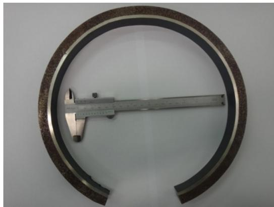
**Figura 1.** Seção do tubo da soldagem por explosão. A parte interna do tubo (mais clara) é o Inconel 625. A parte externa (mais escura) é o aço API 5L X-60.
