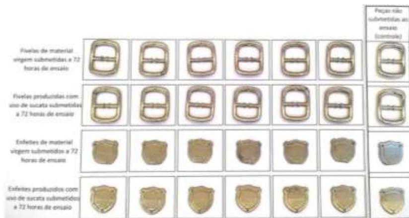
**Figura 9:** Fotografias da frente das amostras fivela e enfeite após ensaio de corrosão.
