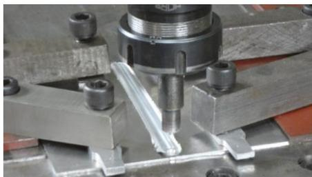
**Figura 2:** Ejecución de soldaduras por fricción agitación.
