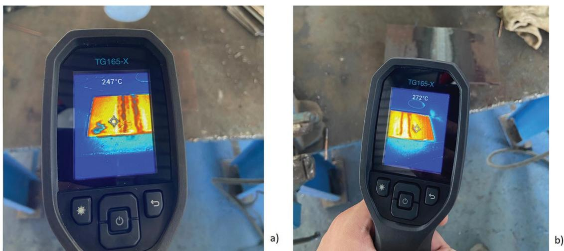
Figura 3: Medições de temperaturas na ZTA através de câmera termográfica logo após soldagem.
