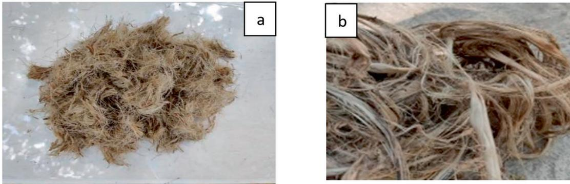
**Figure 1:** a) Kenaf fibres b) Jute fibre.
