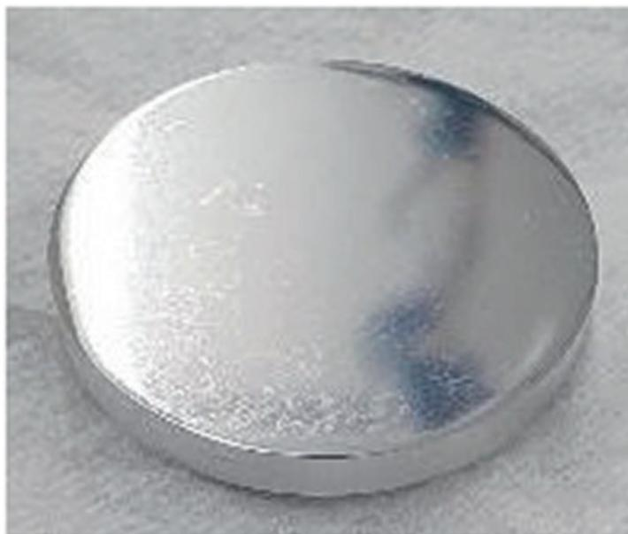
**Figura 1:** Amostra de controle polida alumínio 6061.
