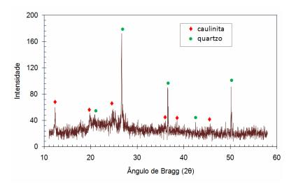
**Figura 1:** Difratograma de raios X do metacaulim.
