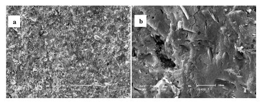
Figura 3: Micrografias obtidas por MEV da pasta geopolimérica em ciclagem na água. (a) 80 x; (b) 1500 x.
