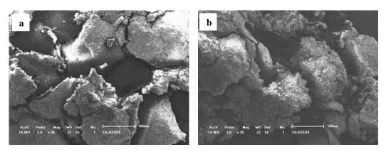
**Figura 5:** Micrografias obtidas por MEV da pasta geopolimérica submetida à ciclagem em ácido sulfúrico. (a) 35 x; (b) 35 x.
