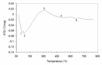
Figura 8: Curva de ATD da pasta geopolimérica submetida ao ataque por sulfato de sódio.
