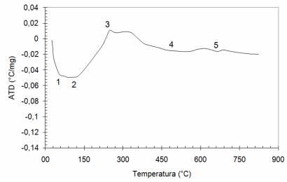
Figura 7: Curva de ATD da pasta geopolimérica submetida à ciclagem em água.
