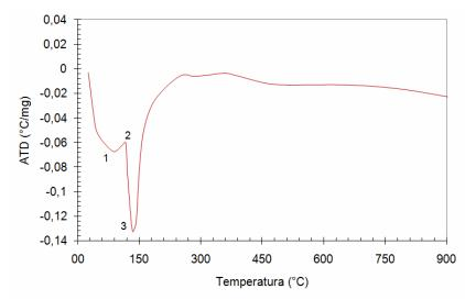
Figura 9: Curva de ATD da pasta geopolimérica submetida ao ataque por ácido sulfúrico.
