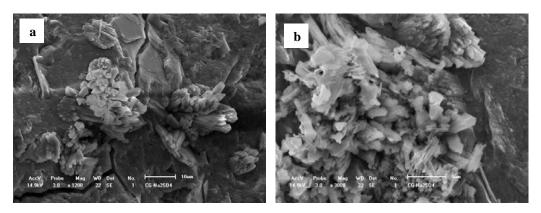
**Figura 4:** Micrografias obtidas por MEV da pasta geopolimérica submetida à ciclagem em sulfato de sódio. (a) 1200 x; (b) 3000 x.
