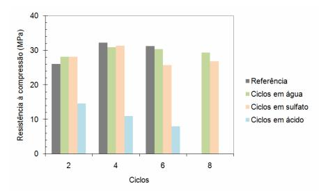
**Figura 2:** Resistência à compressão axial das argamassas geopoliméricas submetidas a diferentes condições de exposição.
