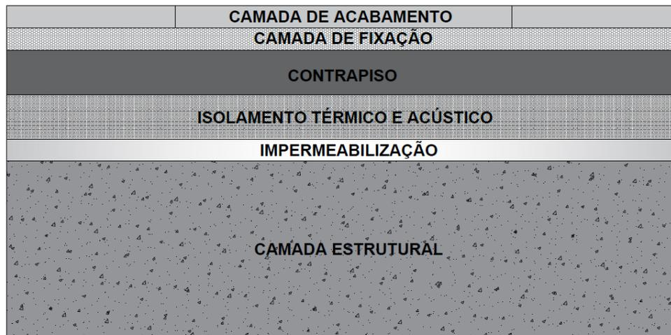
**Figura 1:** Exemplo de sistema de piso com indicação de camadas.
