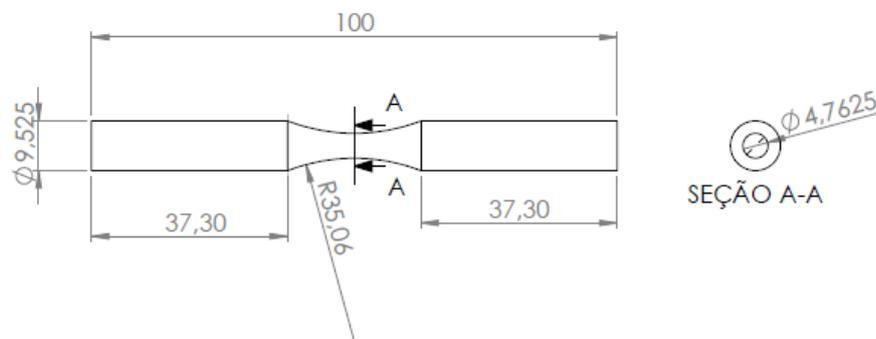
**Figura 1:** Desenho do corpo de prova.
