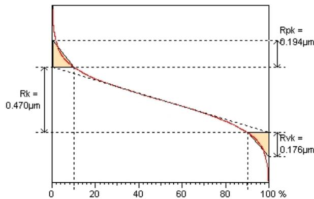
Figura 7: Exemplo de curva razão de material.
