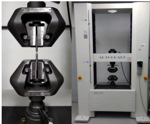
**Figura 2:** Máquina de tração utilizada.
