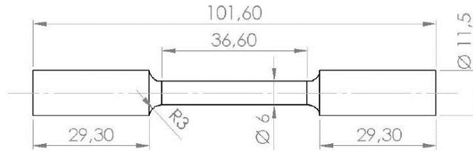
Figura 3: Desenho do corpo de prova para tração.
