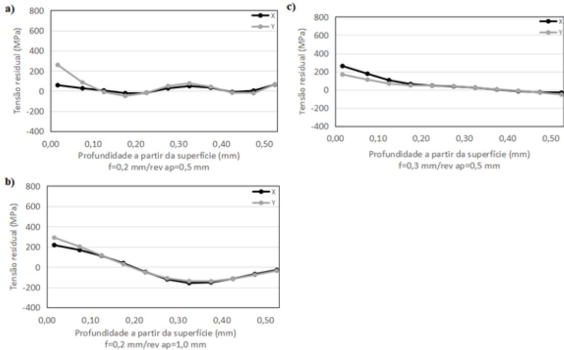
Figura 9: Tensões residuais para as amostras torneadas sob velocidade de corte de 30 m/min.
