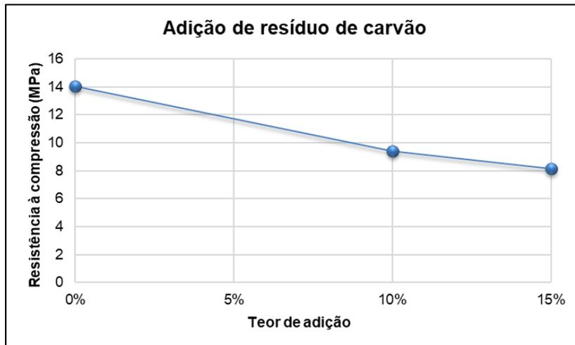
**Figura 13:** Resistência mecânica das argamassas com adição de resíduo de carvão.
