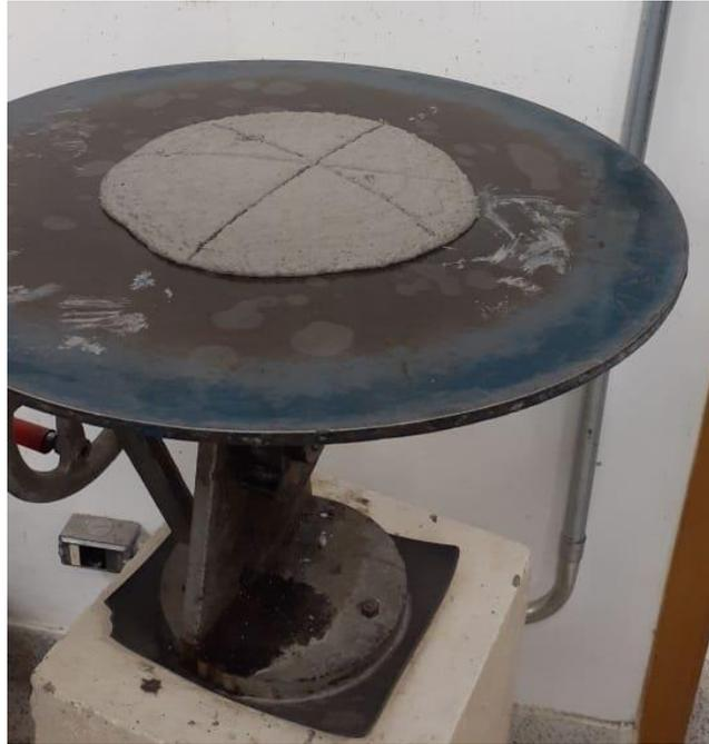
**Figura 5:** Ensaio de consistência.
