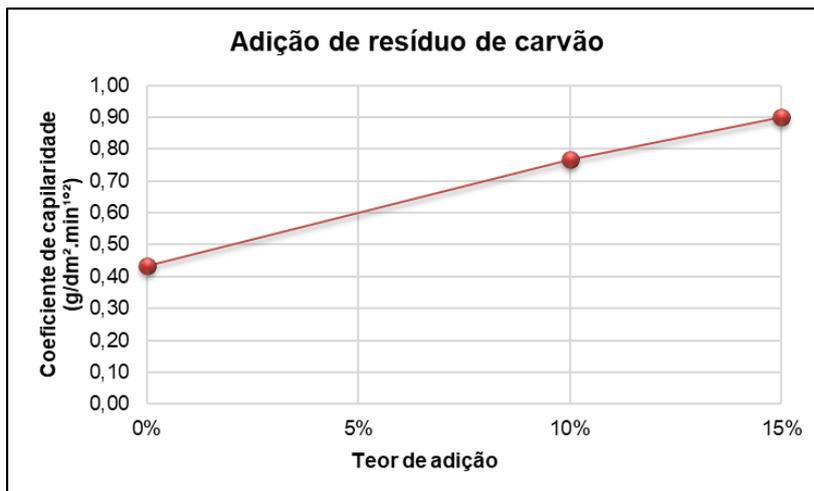
Figura 9: Coeficiente de capilaridade das argamassas com adição de resíduo de carvão.
