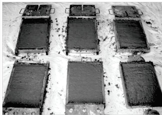
Figura 4 – Corpos de prova para ensaios de compressão e tração (10 cm x 20 cm)
