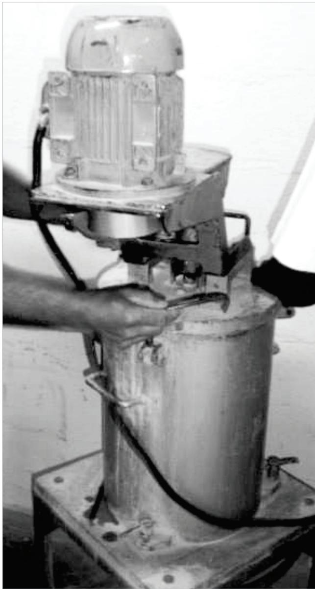
baseou-se na queda livre de uma esfera com massa conhecida sobre o centro de um corpo de prova de concreto colocado em uma caixa de areia padronizada.
