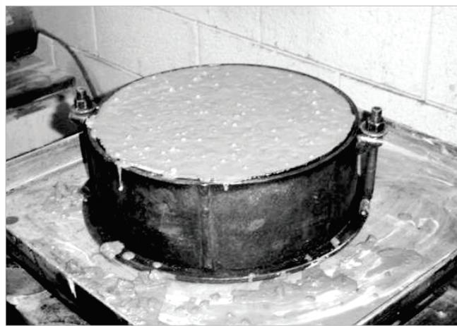
Figura 3 – Moldagem de corpos de prova para ensaio de impacto (5 cm x 15 cm x 30 cm)
