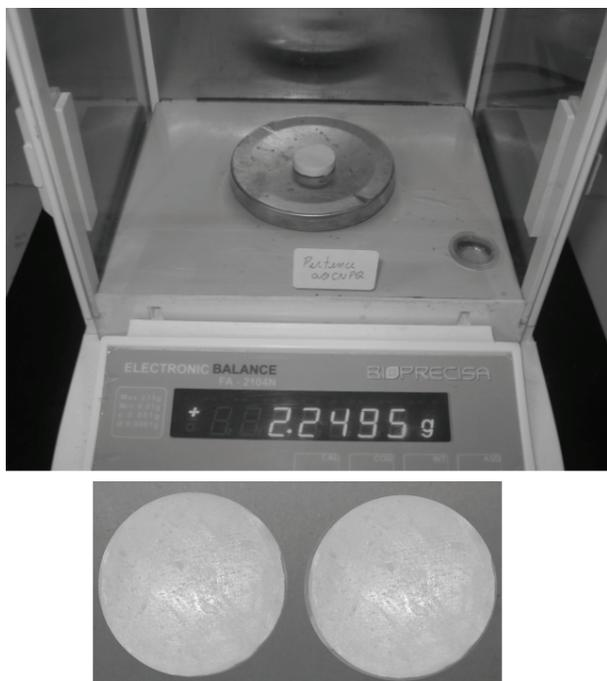
**Figura 1 – Tablete de Optosil sendo pesado na balança analítica de precisão para ajuste do peso. Aspecto final ampliado do tablete.**
