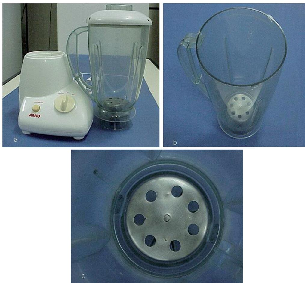
**FIGURA 1.** Despolpador de sementes: remoção de mucilagem presente nas sementes. a) liquidificador adaptado b) vista lateral c) vista frontal da peça adaptada. \* Desenvolvido na Embrapa Mandioca e Fruticultura Tropical.
