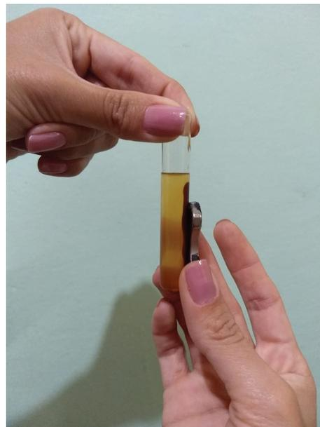
**Figura 1:** Solução de NPmag orientadas na presença de um campo magnético externo (na presença de um ímã).
