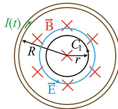
Figura 7: Corte transversal de un solenoide por el que circula una corriente  $I$ .
