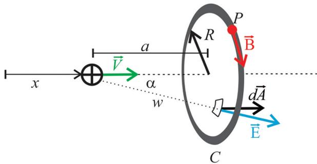
**Figura 2:** Configuración geométrica para el cálculo de la corriente de desplazamiento del ejemplo 1.
