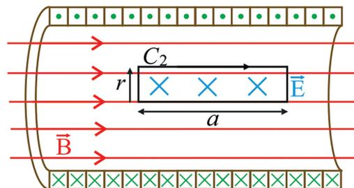
Figura 8: Corte longitudinal del solenoide. El campo magnético es horizontal hacia la derecha.
