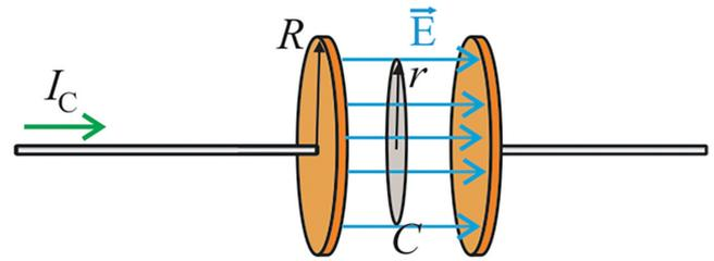
**Figura 4:** Representación del campo eléctrico entre las placas del capacitor y una curva cerrada  $C$ .
