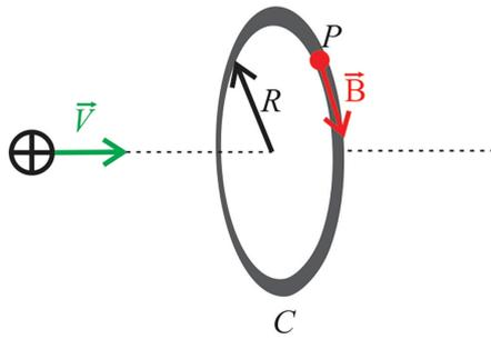
**Figura 1:** Una partícula cargada realizando un MRU respecto a un sistema de referencia inercial  $R$ .
