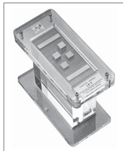
**Figura 1.** Phantom Cromox® de referência em absorptimetria óssea construído com espécimes ósseos medidos no laboratório de metrologia do IPT e usado para calibração de máquinas Cromox®.
