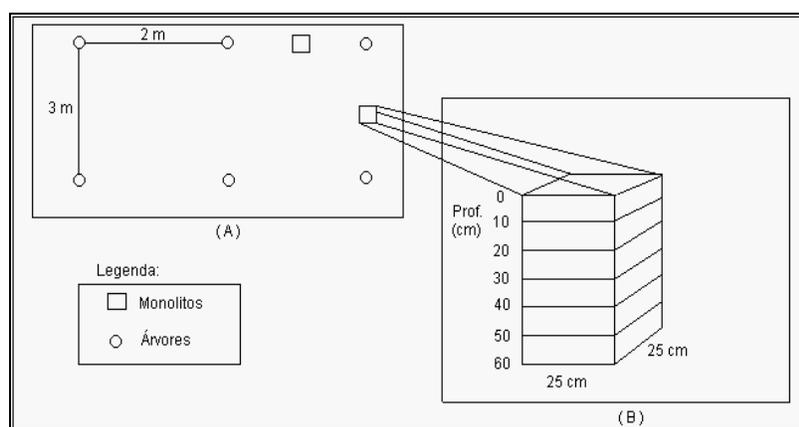
**Figura 1** – Representação esquemática da amostragem: (A) detalhe da amostragem no povoamento (espaçamento 3 x 2 m), monólitos na linha e na entrelinha e (B) detalhe do monólito e suas divisões de 10 em 10 cm, de 0 até 60 cm de profundidade.
