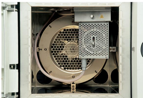
**Figura 2.** Módulo de aquecimento ultrarrápido instalado no forno de um cromatógrafo convencional (Thermo Fisher Scientific Inc.®)
