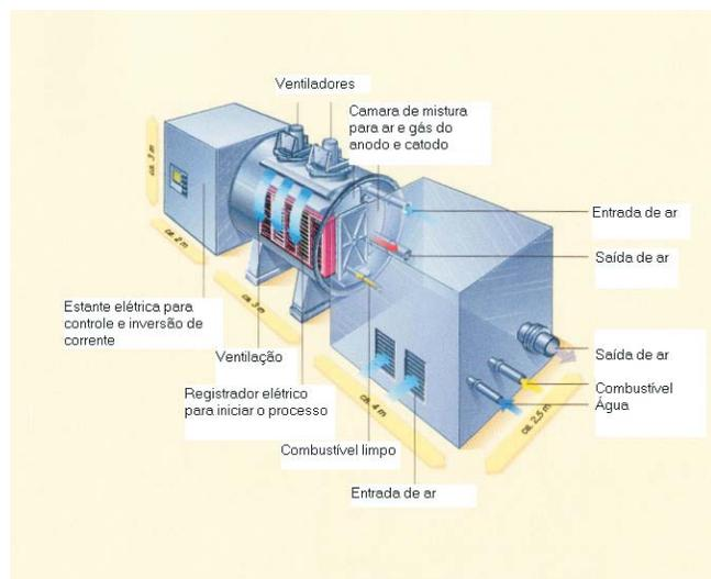
Figura 5. Esquema do chamado HOT MODULE da empresa MTU, Friedrichshafen, Alemanha
