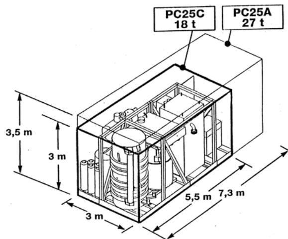
Figura 3. Esquema da construção da instalação ONSI PC25C de 200 kW (elétrico)
