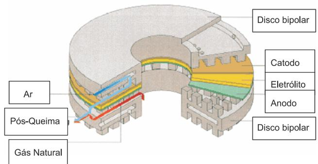
**Figura 8.** Esquema do sistema HEXIS da empresa Sulzer
