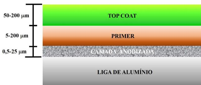
Figura 9. Ilustração esquemática dos componentes de um sistema de proteção das ligas de alumínio. Baseado na ref. 165
