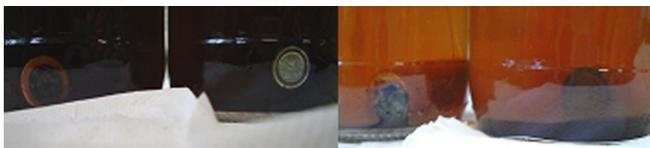
**Figura 3S.** Aspecto do polo negativo de pilhas Zn-C I expostas à ação do chorume após 7 dias (esquerda) e 30 dias (direita)
