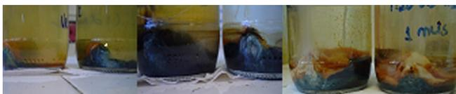
**Figura 1S.** Aspecto do polo negativo de pilhas alcalinas expostas à ação da água do mar após 1 dia (esquerda), 7 dias (centro) e 30 dias (direita)
