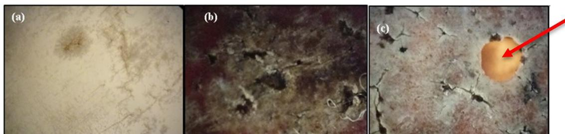
**Figura 11.** Imagens obtidas por microscopia óptica com aumento de 40x no campo escuro, após 90 dias de degradação para as amostras: (a) PCLp; (b) PCLp/10% natural e (c) PCLp/10% acetilada.
