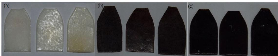
**Figura 6.** Imagens das amostras para a degradação em solo: (a) PCLp; (b) compósito com 10% borra de café natural; (c) compósito com 10% de borra de café acetilada.
