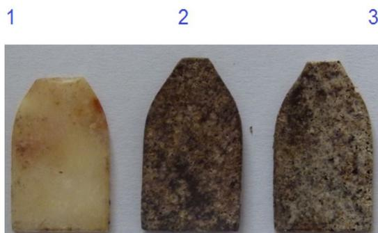
**Figura 14.** Imagens fotográficas obtidas após 120 dias de biodegradação em solo para o PCLp (1) e os compósitos com 10% de fibra natural (2); 10% de fibra acetilada (3).
