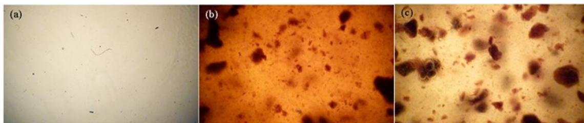
**Figura 7.** Imagens obtidas por microscopia óptica com aumento de 40x no início da degradação: (a) PCLp e os compósitos com (b) 10% de fibra natural (c) 10% de fibra acetilada.
