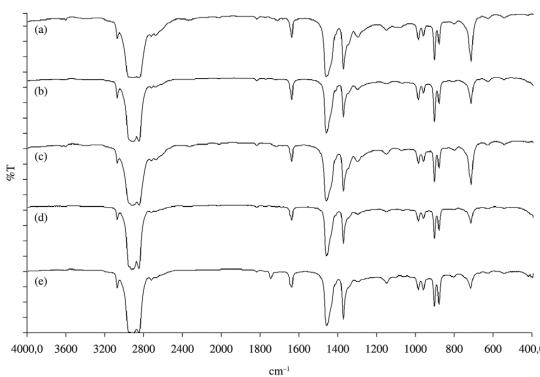
**Figura 2.** Espectros FT-IR (pirólise em bico de Bunsen) de algumas amostras de EPDM, com teor (%) de ENB conhecido: a) Nordel IP 4770 (4,75), b) Keltan 8570 (5,0), c) Royalene 539 (5,3), d) Keltan 21(6,3), e) EP342 (9,5).
