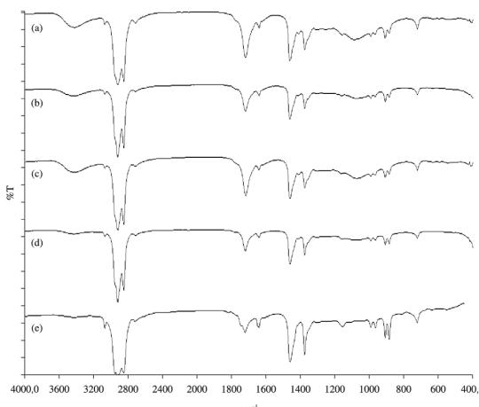
**Figura 1.** Espectros FT-IR (pirólise controlada) de algumas amostras de EPDM, com teor (%) de ENB conhecido: a) Nordel IP 4770 (4,75), b) Keltan 8570 (5,0), c) Royalene 539 (5,3), d) Keltan 21(6,3), e) EP342 (9,5).
