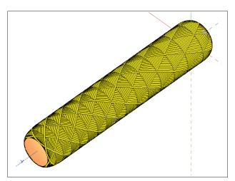
Figura 14: Vista isométrica traseira da simulação de bobinagem com padrão de bobinagem baixo
