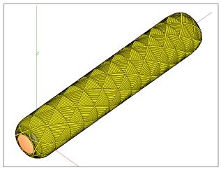
Figura 13: Vista isométrica frontal da simulação de bobinagem com padrão de bobinagem baixo
