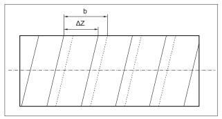
Figura 7: Grau de cobertura >100% em mandril cilíndrico onde b é a largura de banda e  $\Delta Z$  o passo de bobinagem.
