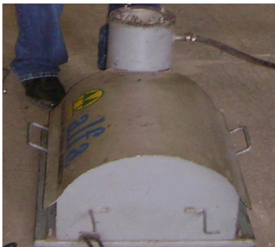
Figura 4. Maquete experimental utilizada para simulações de explosões. Fonte: Elaboração dos autores.
