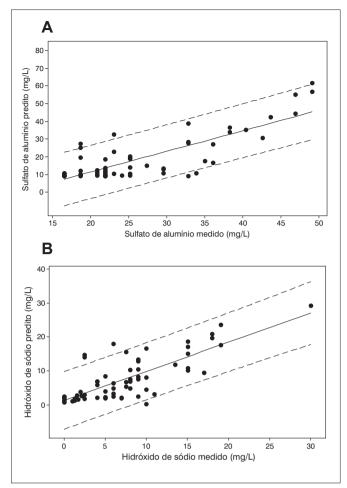
**Figura 3 -** Relação entre os valores medidos e preditos de (a)  $Al_2(SO_4)_3$ .  $nH_2O$  e (b) NaOH (linha contínua) para do conjunto de teste. As linhas tracejadas indicam o intervalo de predição de 95%
