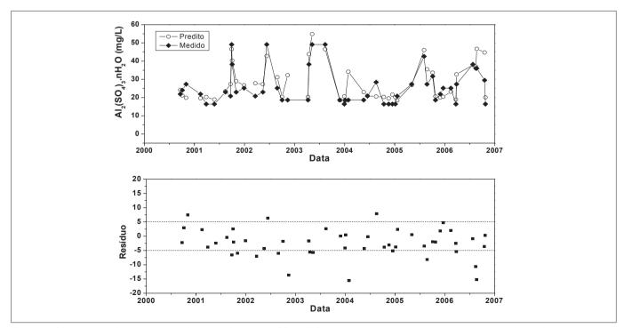
Figura 4 - Séries temporais de valores preditos e medidos de Al<sub>2</sub>(SO<sub>4</sub>)<sub>3</sub>.nH<sub>2</sub>O (superior) e resíduos para o conjunto de teste (inferior)
