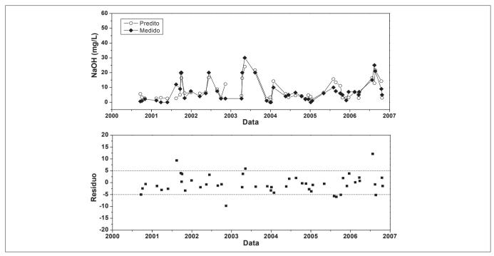
Figura 5 - Séries temporais de valores preditos e medidos de NaOH (superior) e resíduos para o conjunto de teste (inferior)
