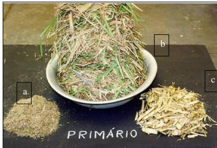
FIGURA 3. Perdas invisíveis, serragem (a) e lascas (c) recolhidas junto com as impurezas vegetais (b) na saída do extrator primário.
