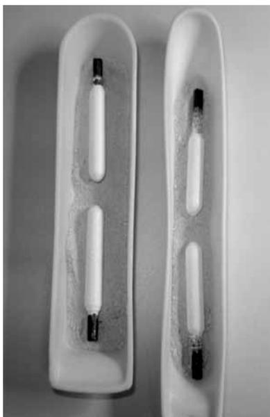
Figura 4: Tubos cerâmicos obtidos por EPD após secagem em meio de KCl (esquerda) e ao ar (direita).
