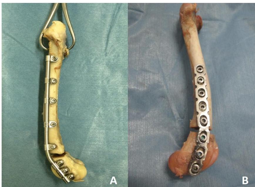
Figura 3. Padrão de posicionamento dos parafusos no grupo CRIF (A) e no grupo placa (B) em fêmur de cadáver de cão.
